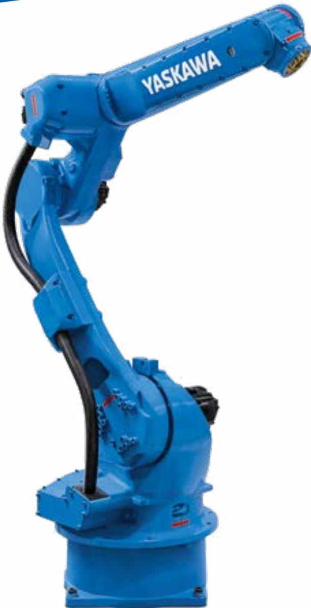
Le MOTOMAN GP20 est un robot industriel 6 axes très polyvalent avec une charge utile pouvant aller jusqu'à 20 kg. Il dispose d'une plage de travail de 1 802 mm et peut atteindre des temps de cycle très rapides avec une excellente précision de répétabilité.
